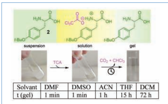
Figure 6 - Système gel-sol-gel à la O-tert-butyl-L-tyrosine alimenté au TCA.
