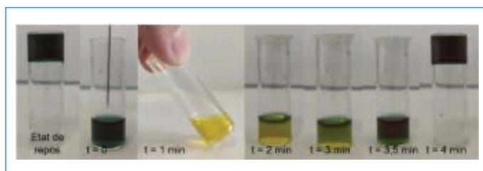
Figure 7 - Cycle gel-sol-gel avec la O-tert-butyl-L-tyrosine dans le DMF. Utilisation de bleu de bromothymol (BTB) et bleu de bromophénol (BPB) comme indicateurs colorés. (Reproduit de [39] avec autorisation, © 2022 American Chemical Society).
